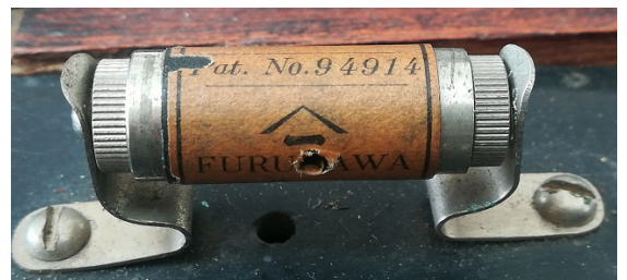
鉱石はFURUKAWA、DETECTORの 表示があり、古河鉱業製と思われます 感度調整用の穴も空いています
